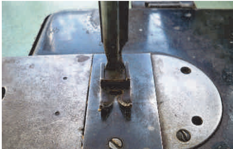
Figura 16. Mekanizmi i gjilpërës te makina zigzag
