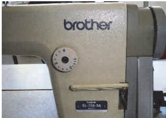
Figura 20. Mekanizmi për rregullimin e distancës në mes dy shpimeve
